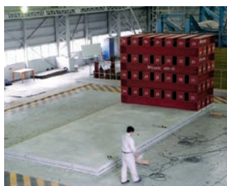
偏在荷重による振れ振動実験
